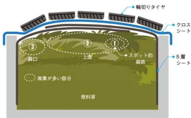
図1. 従来の密封体系と廃棄が多かった部分 (バンカーサイロを横から見た図)
