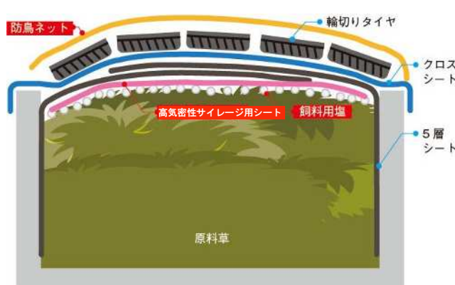
図2. 新しい密封体系 (バンカーサイロを横から見た図)
